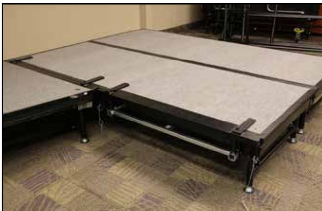
6. Levante el descanso o descanso en curva levemente mientras lo desliza hacia el borde inferior de la sección de rampa y conecte el conjunto de abrazadera inferior al extremo inferior de la sección de rampa.
