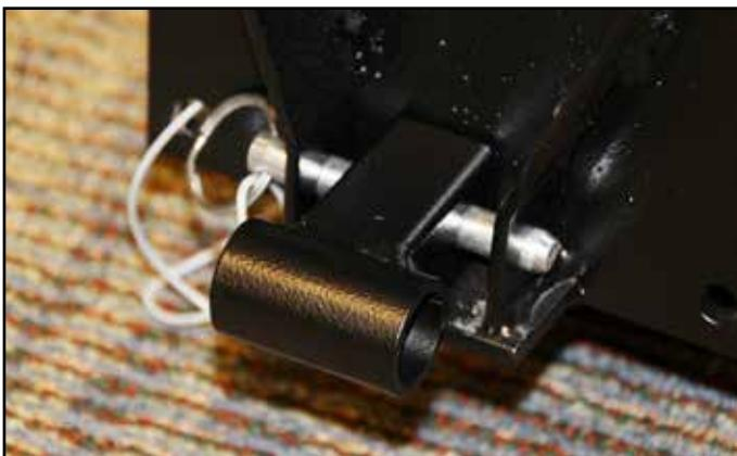
El conector en el extremo superior de la sección de rampa de cuña está diseñado para conectarse al extremo inferior de la sección de rampa de puente. Cuando la sección de rampa de cuña se conecta a un escenario o descanso o descanso en curva, se requieren dos conectores especiales (número de pieza 118309B) para conectar la sección de rampa de cuña a un conjunto de abrazadera superior.
